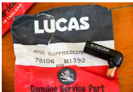
Originale Lucas tændrørshætter med indbygget modstand. (Suppressor). (MGAguur)
