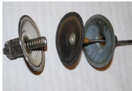
Destruktiv adskillelse af vakuumregulatoren.
