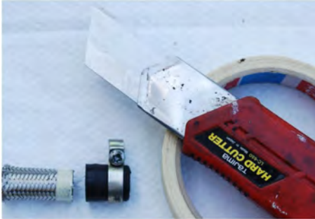
Her er hvad du skal bruge, hvis du skal afkorte en benzinslange med flex. Fotoet viser slangen efter at den er afkortet med et rent snit.
