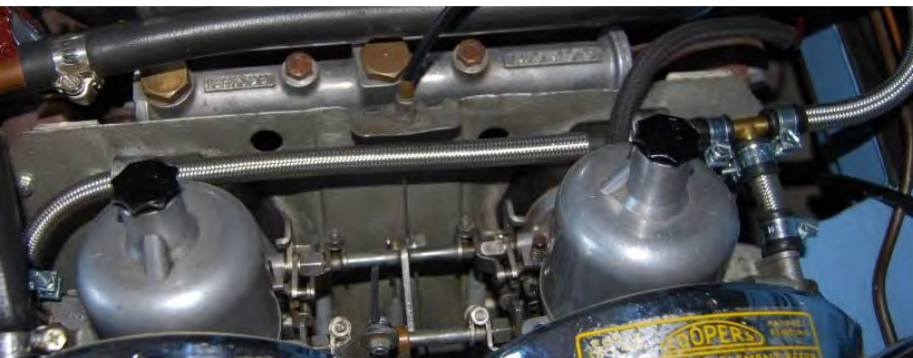
Sådan skal slangerne ligge efter evt. afkortning. Læg mærke til at slangerne befinder sig på den rigtige side af varmeskjoldet og at de sidder lavt og nærmest trykker sig ind mod karburatorerne.
