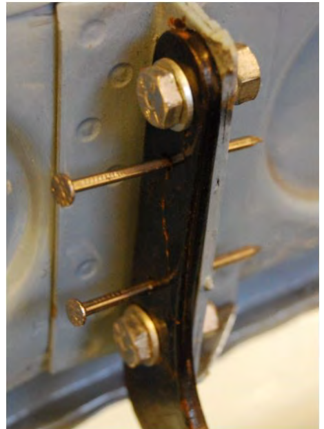
Når boltene er løst stikkes et par Ø 3mm søm (eller tilsvarende) ind i hullerne og boltene spændes. Herefter sidder hjelmen som den skal - nemt og bekvemt.
