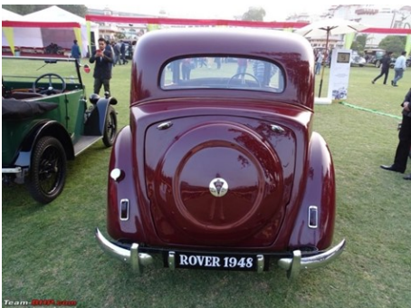
Rover P4 har reservehjulet liggende i bunden af bagagerummet, hvilket betyder at al bagage skal ud på vejen for at komme til det ved en punktering. Desværre meget almindeligt i mange fabrikater og modeller.
