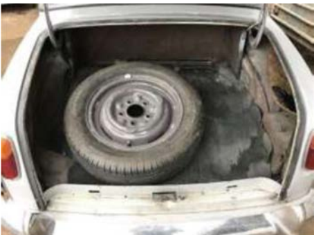
Rover P4 har reservehjulet liggende i bunden af bagagerummet, hvilket betyder at al bagage skal ud på vejen for at komme til det ved en punktering. Desværre meget almindeligt i mange fabrikater og modeller.
