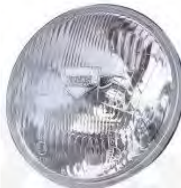
Lucas F700 parabolen er en rigtig klassiker, men med en dårlig lysfordeling på nærlýset.
