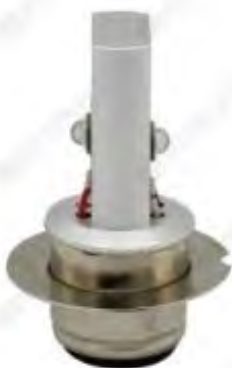
LED lyskilde med BPF fatning. Læg mærke til de to lysdioder, den venstre sidder længst fremme og lyser opad når den er monteret i parabolen - det er nærlyset! På det lange lys lyser begge dioder.
