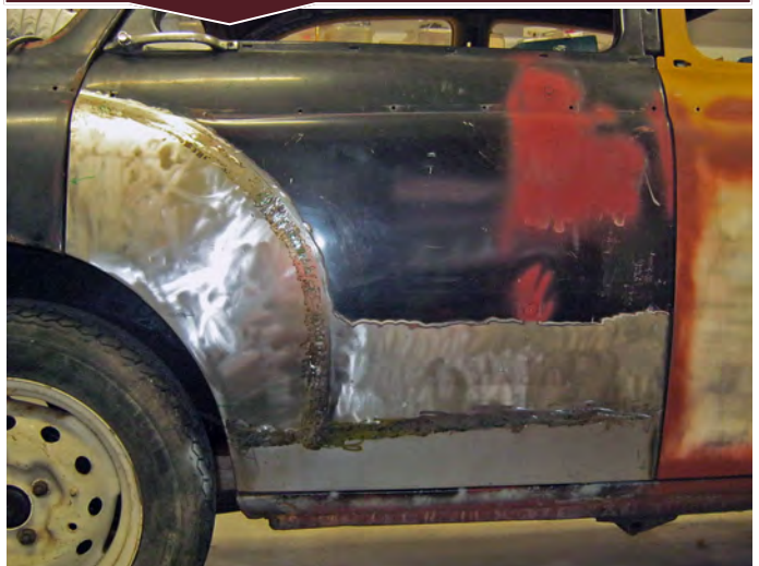
Højre dør fik svejset en del ny plade på. Døren fra doner bilen var bedre, men den passede dårligt. Her fik jeg også afprøvet tin spartling.
