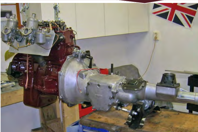
Motor og gearkasse klarede at blive løftet ned i bilen
