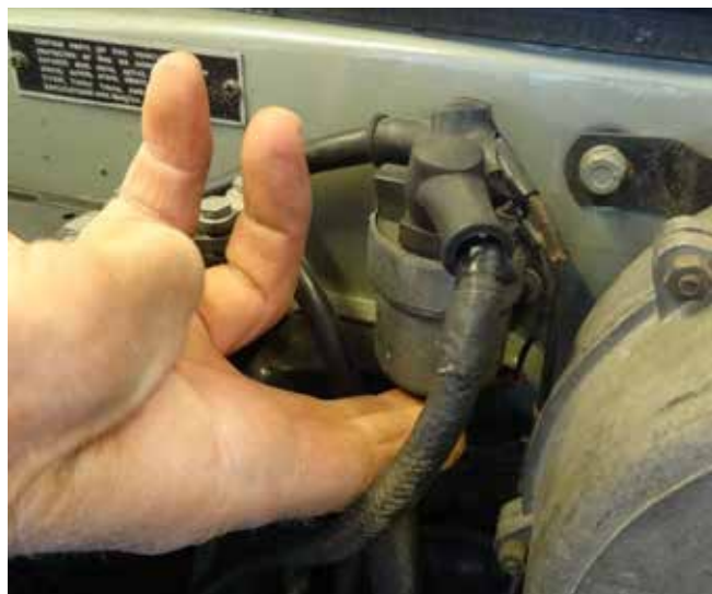
Fig. 56-4 Sådan aktiveres startrelæet på Magnetten.
