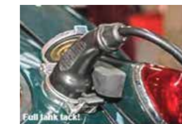
Fig. 52-4 Ladestikket er naturligvis anbragt under tankdækslet.
