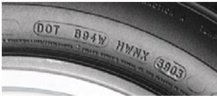
Dans l'exemple présenté, le pneu a été fabriqué pendant la 39<sup>ème</sup> semaine de l'année 2003. Il est plus que temps de le changer ! Les fabricants estiment la durée de vie d'un pneu entre 5 à 10 ans en considérant qu'il a été utilisé dans des conditions idéales. En réalité, le pneu subit de nombreuses agressions qui dégradent peu à peu les qualités mécaniques du caoutchouc : sous gonflage (fréquent), exposition au soleil (fréquent), contact avec les hydrocarbures...
