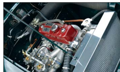
1950 ccm med Crossflow topplokk og 2 doble Weber 45 DCOE. Her er det 160 hester å leke seg med, dette gjør bilen til den sportsvogna den skulle vært fra fabrikk den gang den var ny.
